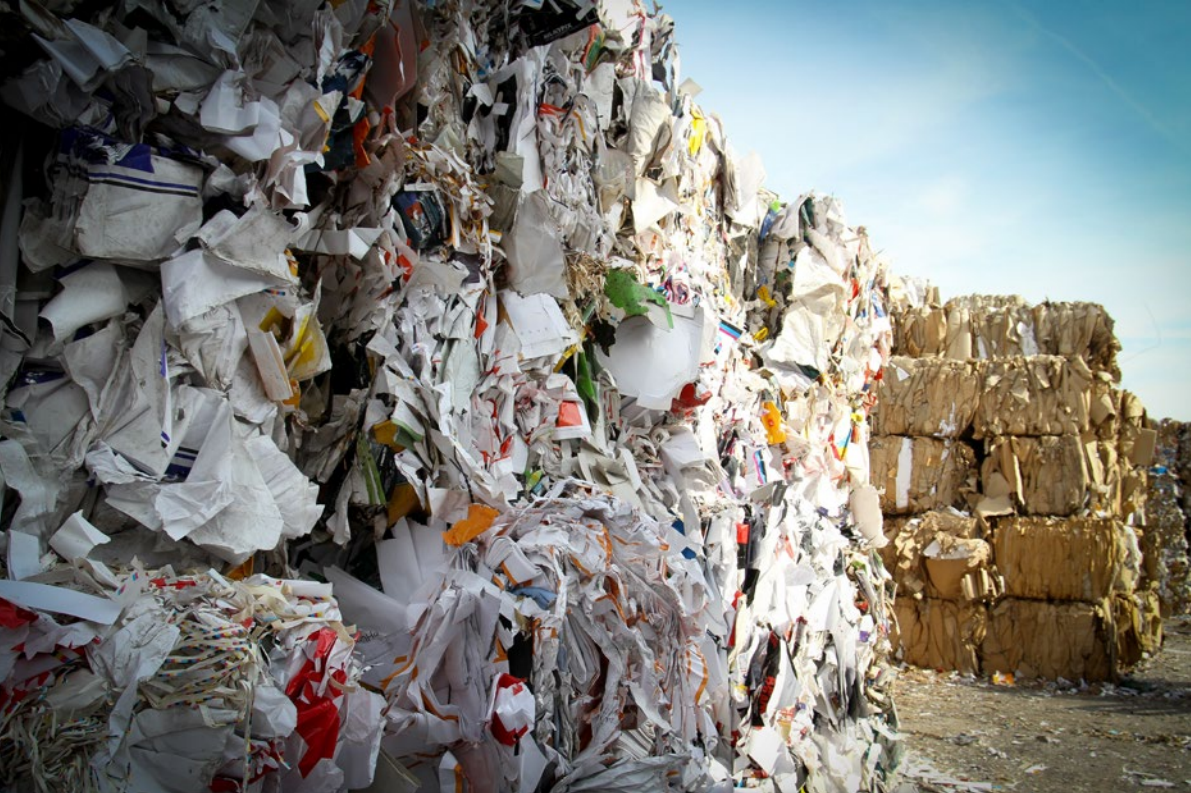
Zu Ballen gepresstes und schon weitestgehend sortenrein erfasstes Altpapier wartet auf die Verwertung
