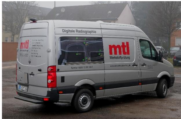
mtl ist ein **akkreditierter** Dienstleister für digitale Radiographie. Für die Darstellung kommen an Stelle von Röntgenfilmen Speicherfoliensysteme (CR) zum Einsatz. Die Systeme können stationär aufgestellt werden oder sind in einem Laborfahrzeug eingebaut und somit flexibel mobil einsetzbar. Die Systeme können sowohl zur Schweißnahtprüfung wie auch zur Wanddickenbestimmung an isolierten Rohrleitungen (Schattenaufnahmen) eingesetzt werden.
